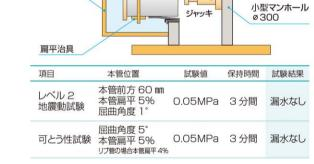
可とう継手部の耐震性・止水性
